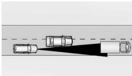
El ACC no detectará a un vehículo por delante hasta que esté completamente en el carril. Puede ser necesario aplicar los frenos manualmente.
