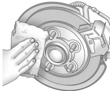
13. Elimine todo el óxido y la suciedad de los pernos de la rueda, las superficies de montaje y la rueda de refacción.
