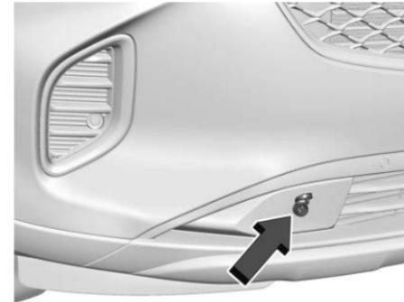
3. Retire la cubierta del conector del calentador del motor haciendo palanca suavemente con una herramienta de punta plana.
