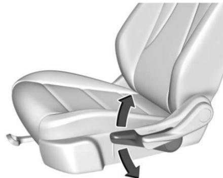
Si está equipado, mueva la palanca hacia arriba o hacia abajo manualmente para subir o bajar el asiento.
