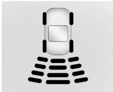
El grupo de instrumentos puede tener una pantalla de Asistencia de estacionamiento con barras que muestran la "distancia al objeto" e información de ubicación de objeto para el sistema de Asistencia para estacionamiento.
