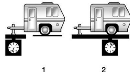
El peso de la lengüeta de remolque (1) debe ser 10–15 % del peso del remolque cargado (2). Algunos tipos de remolques específicos, como remolques de bote, están fuera de estos rangos.
