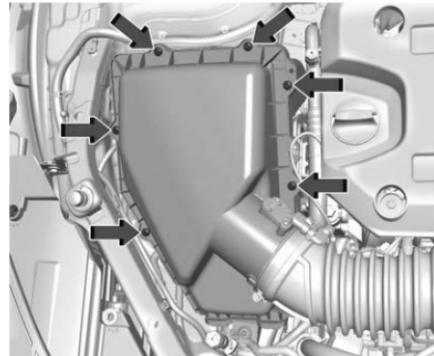
1. Quite los seis tornillos sobre la caja del depurador/filtro del aire del motor.
