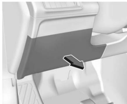
El bloque de fusibles del tablero de instrumentos está en el lado del conductor del tablero de instrumentos, entre el volante y la puerta. Para tener acceso a los fusibles, retire el tablero, comenzando en la parte superior. Una vez que se desconecten los sujetadores, se pueden desactivar las lengüetas a lo largo de la parte inferior de la puerta del tablero de instrumentos para retirar la puerta.
