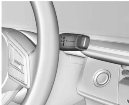
El patrón de cambios se muestra en la parte delantera de la palanca de cambios. La posición de velocidad seleccionada se iluminará en rojo
