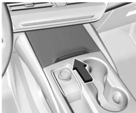
Para abrir el compartimento de almacenamiento delantero, deslice la cubierta hacia adelante. Para cerrar, empuje la cubierta hacia adelante y suéltela.
