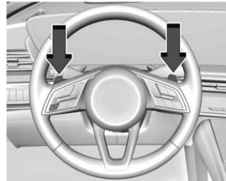
Los vehículos con Cambio con paletas tienen controles en la parte trasera del volante de dirección para cambiar manualmente la transmisión automática.
