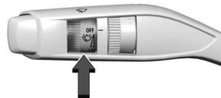
Con el vehículo encendido, mueva la palanca del limpiaparabrisas para seleccionar la velocidad del limpiador.
