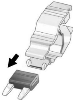
3. Use el extractor de fusible para retirar el fusible de la parte superior o lado, como se muestra anteriormente.
