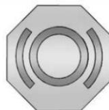
El depósito del cilindro maestro de frenos se llena con líquido de frenos DOT 4 aprobado por GM, como se indica en el tapón del depósito. Vea en *Vista general del compartimiento del motor* ⇨ 254 la ubicación del depósito.
