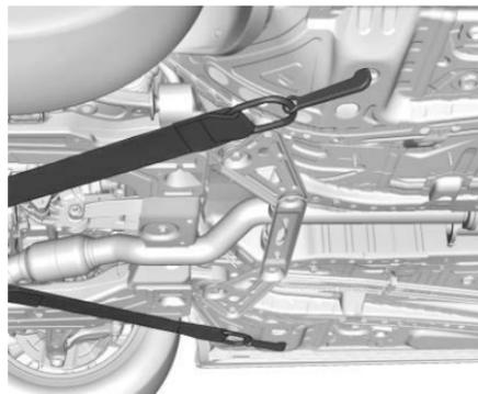
El vehículo está equipado con puntos de conexión específicos que serán usados por el proveedor de remolque. Estos orificios se puede
