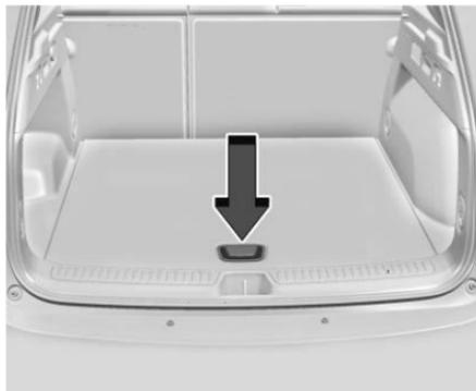
Hay almacenamiento debajo del piso de carga. Presione la manija, jale hacia arriba el piso de carga, y pliegue hacia adelante para tener acceso.
