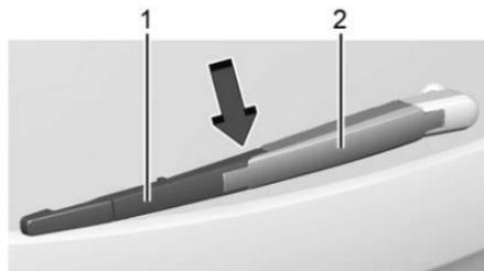
2. Mientras sostiene el brazo del limpiador, presione hacia abajo en el extremo del ensamblaje de la hoja del limpiador (1) donde
