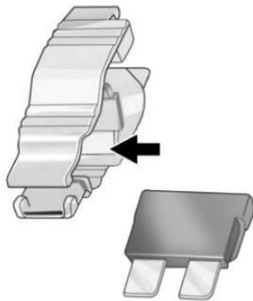
4. Si el fusible se debe reemplazar de inmediato, utilice temporalmente un fusible de reemplazo con el mismo amperaje del bloque de fusibles. Elija una función del vehículo que no sea necesaria para operar el vehículo con seguridad. Repita los pasos 2-3.
