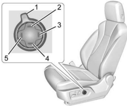
Para vehículos equipados con soporte lumbar y masaje, mueva la Selección de función (1) una o más veces para mostrar los ajustes de soporte lumbar en la pantalla de infoentretenimiento. Presione los botones de ajuste como se muestra anteriormente.
