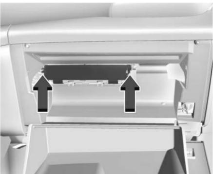
3. Suelte los pestillos en los lados de la puerta de servicio. Abra la puerta de servicio y retire el filtro usado.
