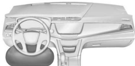
La bolsa de aire de rodillas del conductor está debajo de la columna de dirección.
