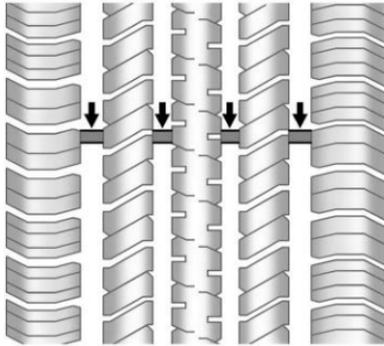
Los indicadores de desgaste del dibujo son una de las maneras de decidir cuándo es el momento para nuevas llantas. Los indicadores de desgaste aparecen cuando las llantas tienen solamente 1.6 mm (1/16 de pulgada) de dibujo remanente. Vea *Inspección de llantas* ⇨ 293 y *Rotación de la llanta* ⇨ 293.
