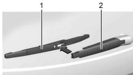
3. Alinee el nuevo ensamblaje de hoja de limpiador (1) con el brazo del limpiador (2) e instale empujando hacia arriba en el ensamblaje de la hoja del limpiador hasta que se asegure en su lugar en el brazo del limpiador.
