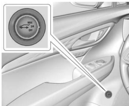
El interruptor de la puerta trasera está en la puerta del conductor. El vehículo debe estar en P (estacionamiento).
