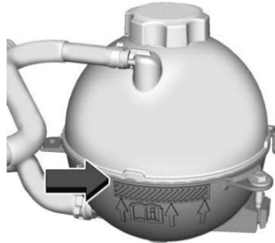
1. Con un sistema frío, agregue refrigerante a la marca indicada en el tanque de compensación.
