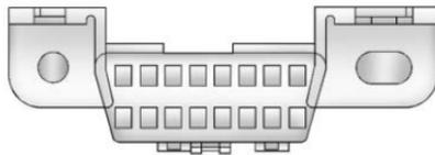
El DLC está debajo del tablero de instrumentos del lado izquierdo del volante. Conectar dispositivos que no se utilicen para realizar una Inspección de emisiones/Prueba de mantenimiento o para dar servicio al vehículo puede afectar la operación del vehículo. Vea *Equipo eléctrico incorporado* ⇨ 249. Visite a su distribuidor si necesita asistencia.
