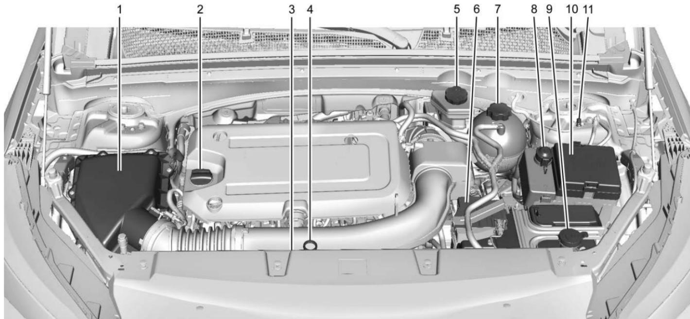
1. Depurador de aire del motor. Vea *Depurador/filtro de aire motor* ⇨ 259.
