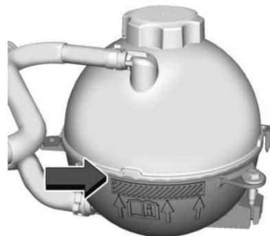
3. Si rellena el nivel en el tanque de compensación de refrigerante, agregue la mezcla adecuada hasta que el nivel alcance la marca en el frente del tanque y vuelva a colocar la tapa. Opere el vehículo. Repita los pasos 1–3, conforme sea necesario.
