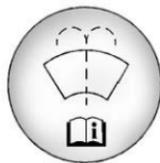
Abra el tapón que tiene el símbolo del lavaparabrisas. Agregue líquido para lavaparabrisas hasta llenar el tanque. Vea en *Vista general del compartimento del motor* ⇨ 254 la ubicación del depósito.
