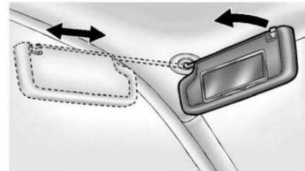
Tire de la visera hacia abajo para bloquear el resplandor. Desconecte la visera del montaje central para pivotarla a la ventana lateral y, si está equipado, para extenderla a lo largo de la varilla.
