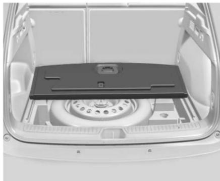
2. Levante y pliegue la parte trasera del piso de carga al frente, jálelo hacia atrás para desconectar los sujetadores, y después jále hacia arriba para retirarlo.
