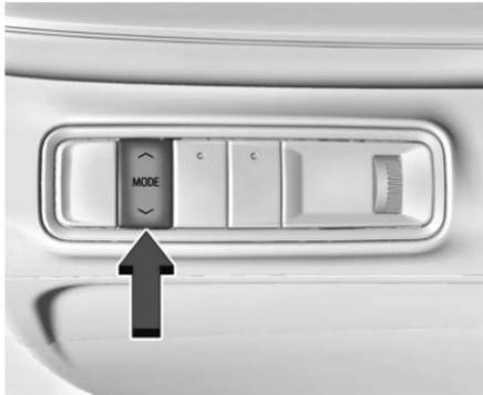
**Interruptor de control de modo del conductor**
